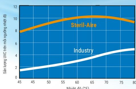
Các thử nghiệm độc lập cho thấy Steril-Aire cung cấp đầu ra gấp 6 lần so với các thiết bị UVC khác trong điều kiện HVAC (50 ° F, tốc độ không khí 400fpm)
